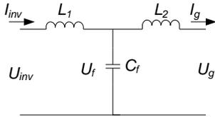
Figure 7.- LCL Filter Single Phase Case
