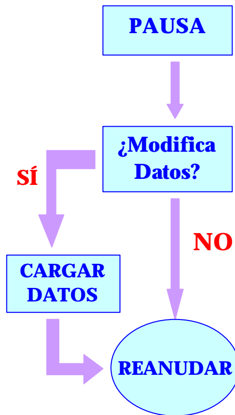
Figura 8: Secuencia lógica del funcionamiento de los controles del entorno gráfico
